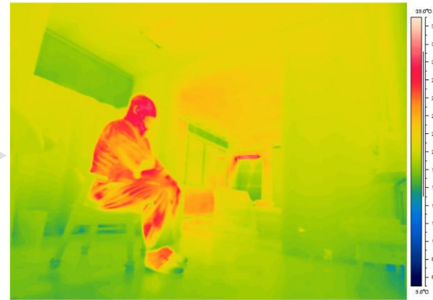
断熱+気密改修後
