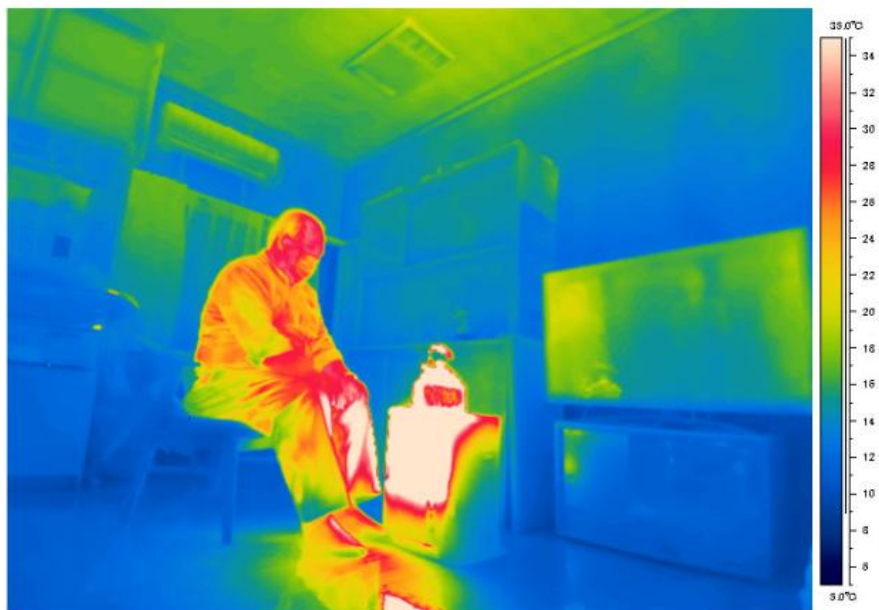
断熱+気密改修前
