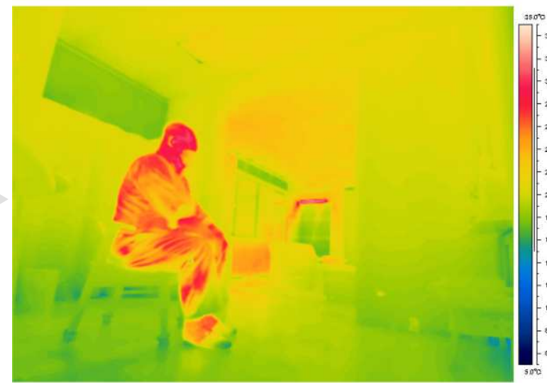
断熱+気密改修後
