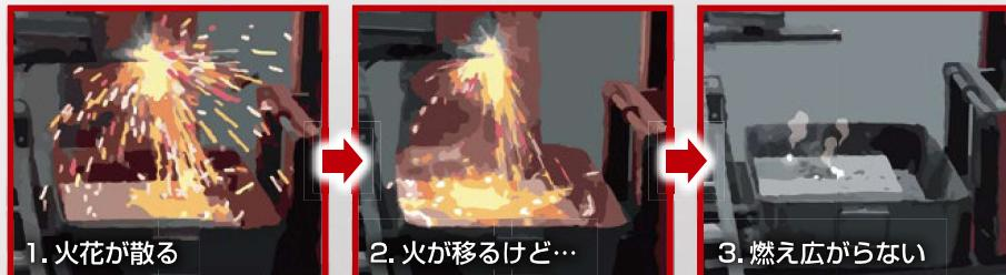
強固な炭化層の形成によって溶接火花がフォーム表面にとどまり内部に侵入しません。
